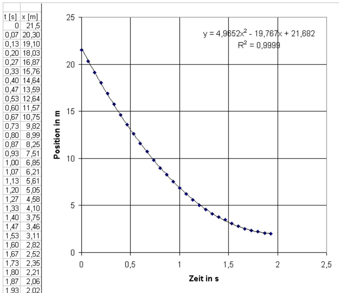
Abb. 3: Zeit-Positions-Diagramm zu einer Vollbremsung (PKW auf trockenem, sehr griffigen Asphalt)
