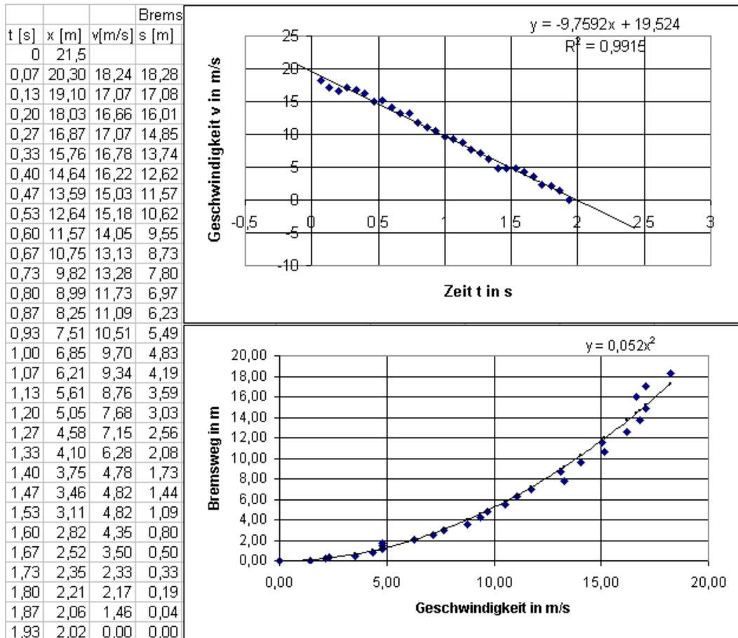
Abbildung. 4a, b Vollbremsung unter optimalen Bedingungen: trockener rauher Asphalt
