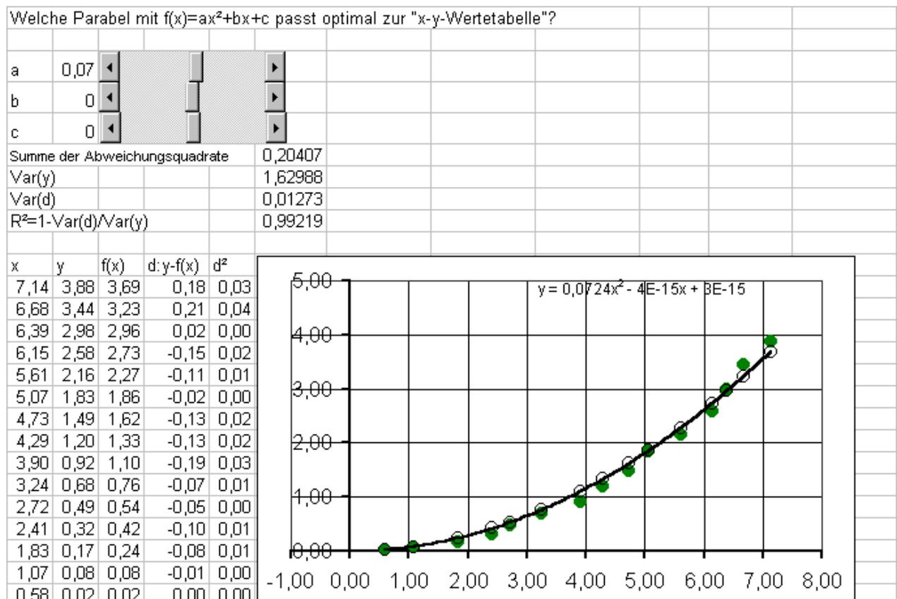
Abb. 5: Wie Excel Trendparabeln und das Bestimmtheitsmaß berechnet. (Die Messdaten stammen hier von einem Vollbremsversuch mit einem Fahrrad, das mit einer Rücktrittsbremse ausgestattet war. Die erste Spalte x enthält die Geschwindigkeit in m/s, die zweite Spalte y den bis zum Stillstand benötigten Bremsweg.
