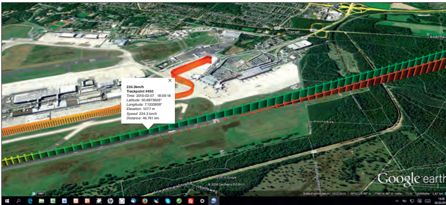
Abb. 2: Landung real (grün/gelb) und im extrapolierten Linearmodell (rot). Der aus ca. 800 m Höhe (bei 400 km/h) aus zwei Positionen A und B im Abstand von 10 s bzw. ca. 1000 m prognostizierte Landepunkt liegt ca. 80 m neben dem realen.
