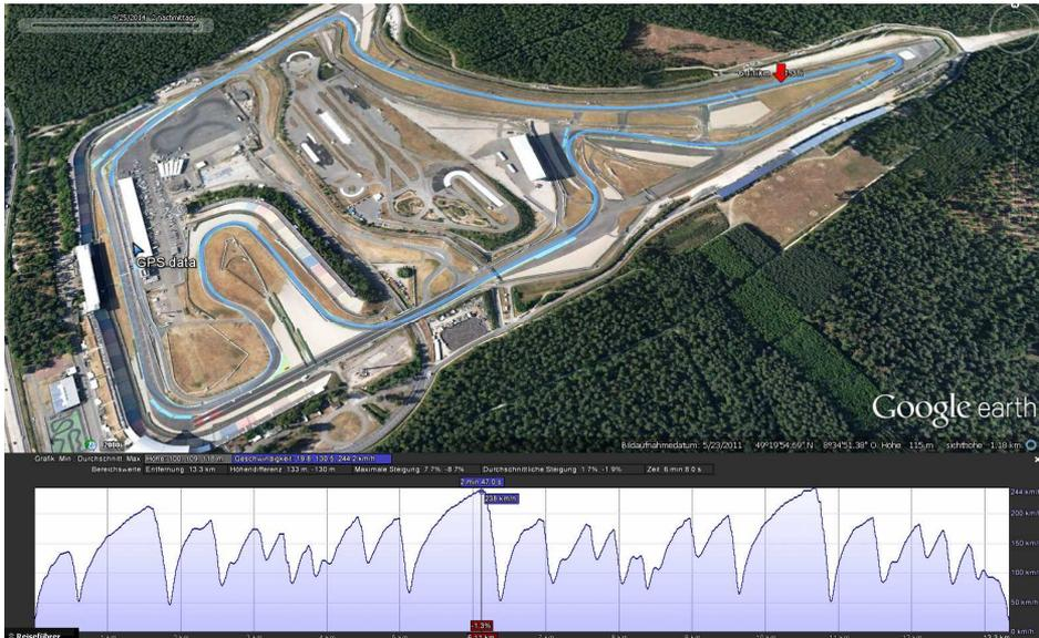
Abb. 11: In Google Earth kann man Tracks samt Geschwindigkeitsprofil (untere Bildhälfte) darstellen und mit dem Videoplayer (oben links) animiert nachfahren. Auf der Nordseite des Ringes fährt das Renntaxi 240 km/h, bevor es in der Nadelkurve (im Osten) auf 60 km/h herunterbremst.
