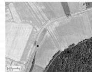
Sind die 70 km/h angemessen? Lade die Luftaufnahme der Landstraße L578 in ein DGS. Stelle dir vereinfachte die Straße aus Ceraden- und einem Kreisbogen zusammengesetzt vor. Ermittle den Radius der Kurve, indem du geschickt einen Kreis einpasst, dessen Radius misst und den im Bild angegebenen Maßstab nutzt.
