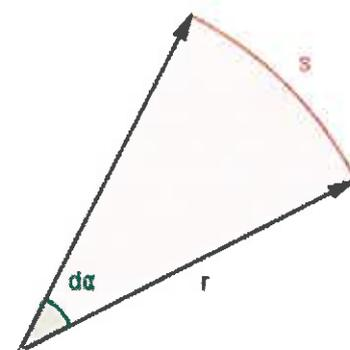
Abb. B: Berechnung des Krümmungsradius  $r$  aus Strecke  $s$  und Drehwinkel  $d\alpha$ :
