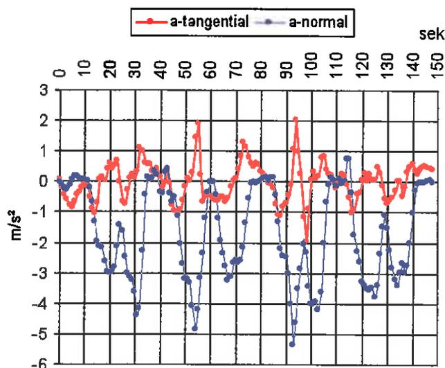
Abb. 4: Tangential- und Quereschleunigung  $a_{tan}(t)$  und  $a_{normal}(t)$
