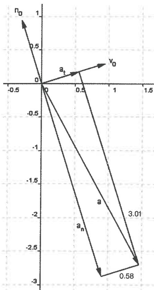
Abb. A: Zerlegung des Beschleunigungsvektors  $\vec{a}_{27}$  in Tangential- und Normalkomponenten
