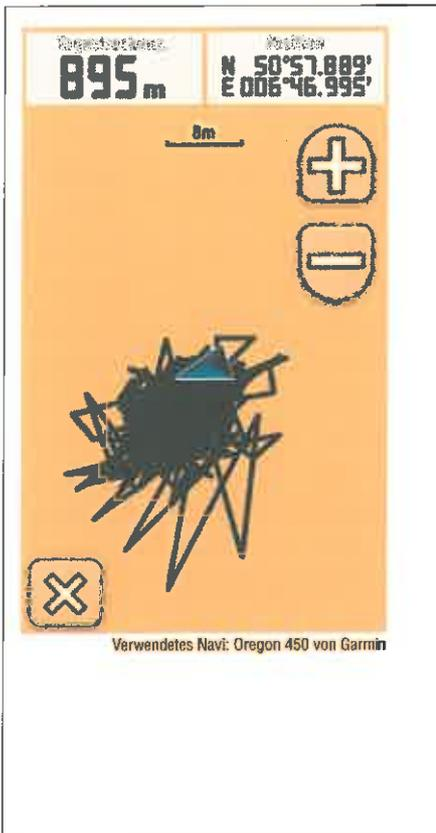
Abb. 1a Track eines ruhenden Empfängers
