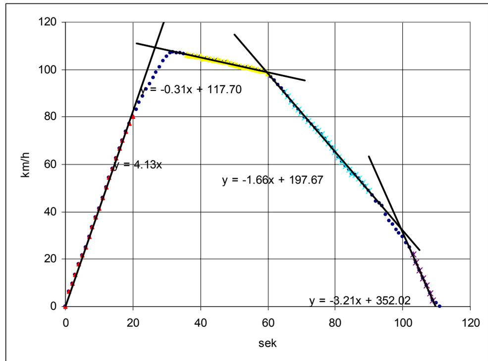
Abb. 13: Zeit-Geschwindigkeitsdiagramm einer S-Bahnfahrt zwischen Köln-Industriepark und Köln-Lövenich. Die Startbeschleunigung ist  $1.15 \text{ m/s}^2$ , gebremst wird mit  $0,09 \text{ m/s}^2$  (Ausrollen),  $0,46 \text{ m/s}^2$  (Vorbremmung) und  $0,89 \text{ m/s}^2$  (Schlussbremsung).
