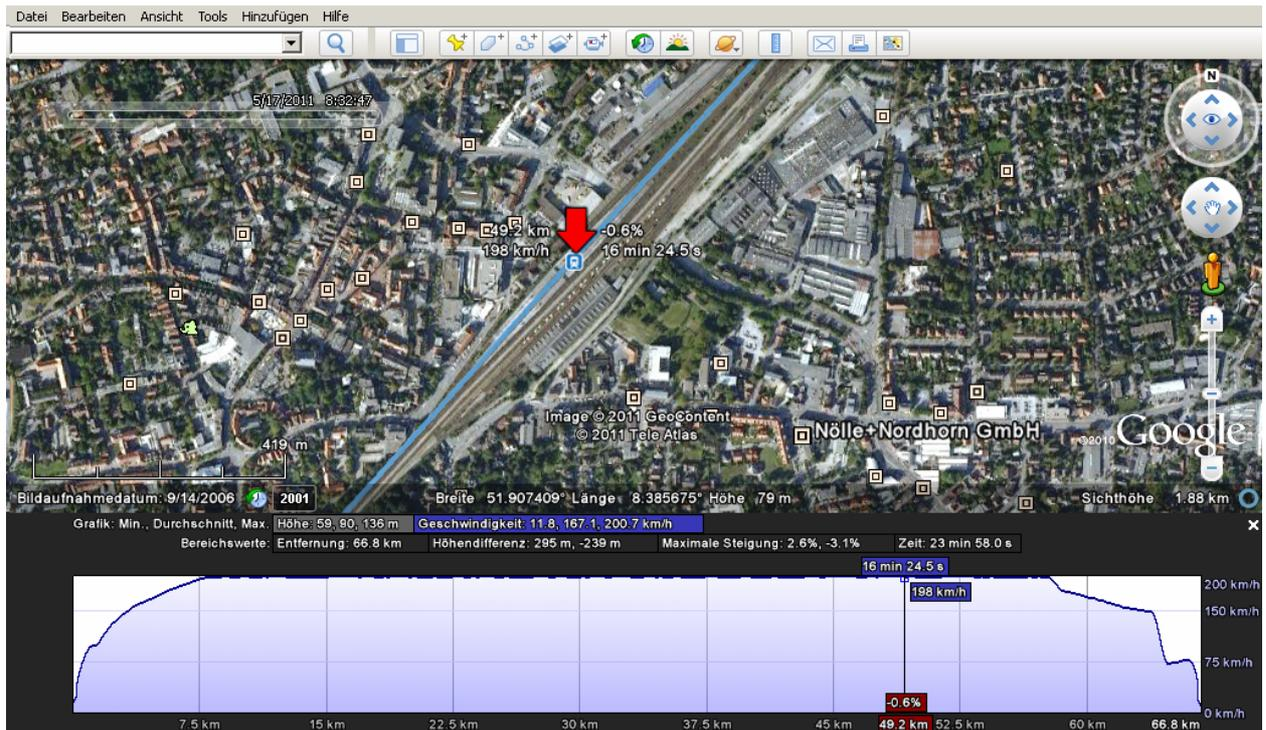
Abb. 7 Track und Weg-Geschwindigkeit Grafik in Google-Earth mit Details in Gütersloh. Man kann die Fahrt durch Klick auf die Zeitleiste oben links animiert nachfahren. Durch Rechtsklick auf den Track wird das Weg-Geschwindigkeitsdiagramm angezeigt. Der ICE 845 fuhr die Strecke zwischen 7,5 km und 58 km konstant mit 200 im/h und nahm den Bahnhof Gütersloh mit 198 km/h.
