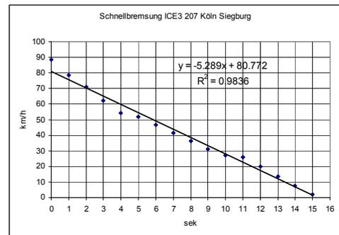
d) ICE-3 Schnellbremsung  $b=-1.47 \text{ m/s}^2$
