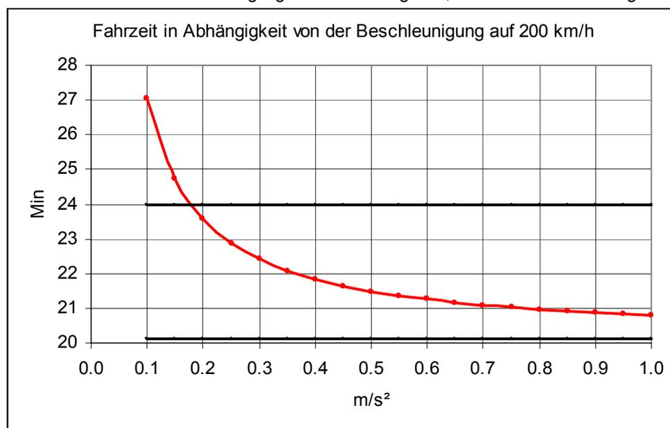
Abb. 12 Modellrechnung: Fahrzeit in Abhängigkeit von der konstanten Startbeschleunigung  $a$  (die Bremsbeschleunigung  $b$  ist doppelt so groß wie die Startbeschleunigung). Bei fliegendem Start mit 200 km/h in Hamm ergäben sich gut 20 Minuten Fahrzeit (untere Asymptote).
