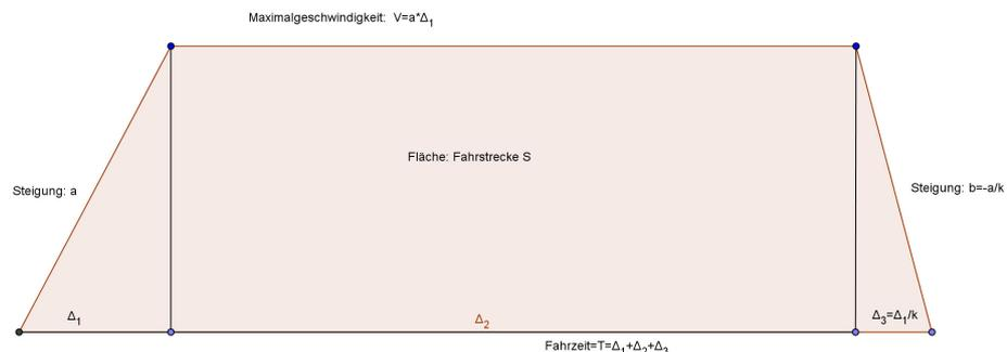
Abb. 11 Zeit-Geschwindigkeitsdiagramm nach dem Modell einer konstant beschleunigten/gebremsten Bewegung
