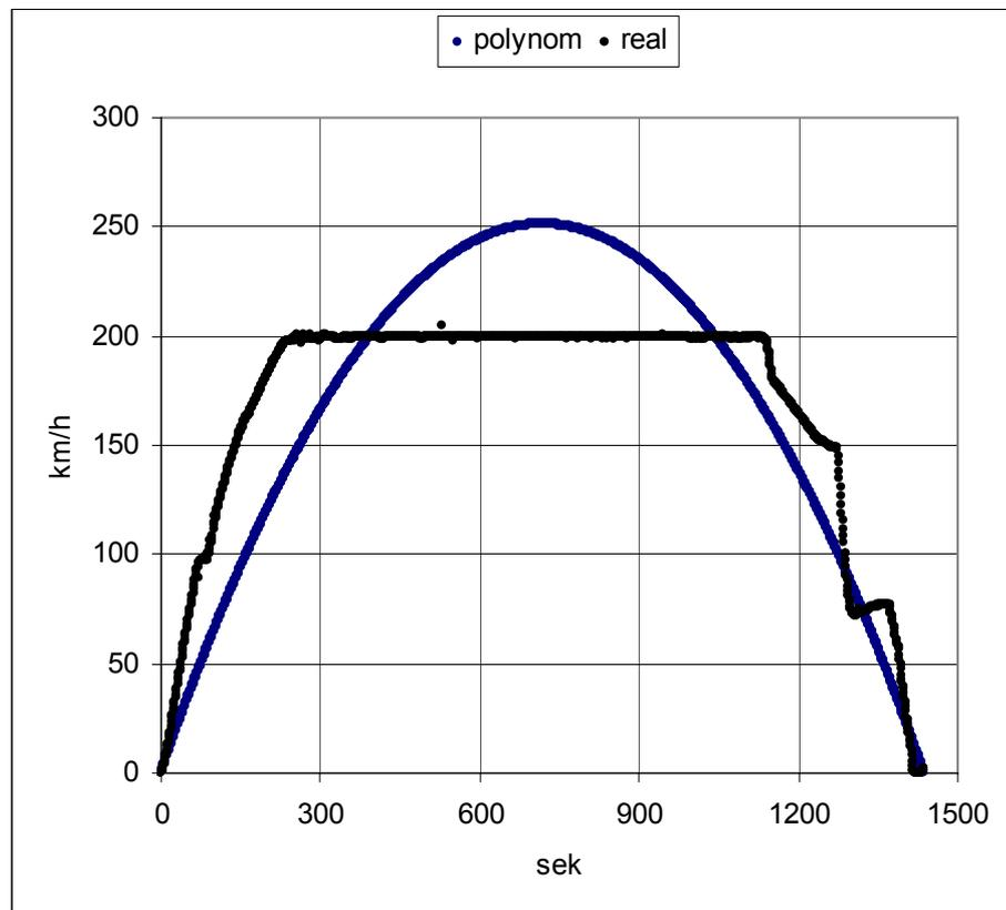
Abb. 8: Gemessene Zeit-Geschwindigkeitsfunktion im Vergleich zum Parabelmodell
