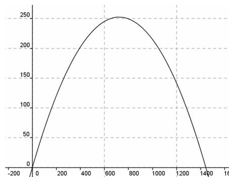
Abb. 2: Aus dem Polynommodell für die Zeit->Weg-Funktion ergibt sich ein Parabelmodell für die Zeit-> Geschwindigkeitsfunktion (Auf der Rechtsachse die Zeit in s abgetragen)
