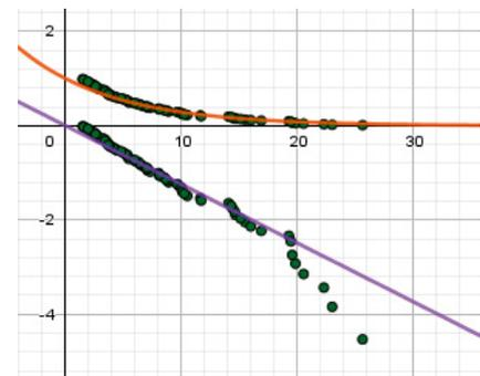
Bild 2: Oben: empirische und theoretische Verteilungsfunktion; unten: beides logarithmiert
